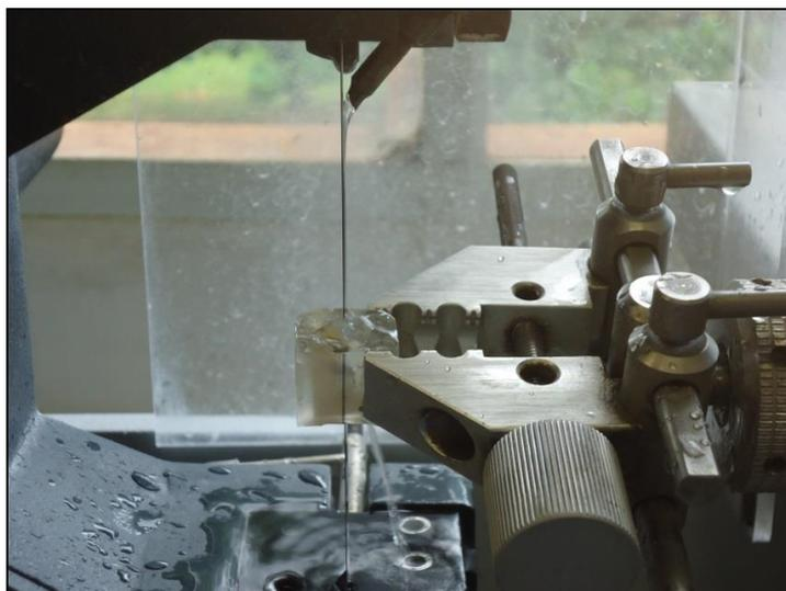
FIGURA 13 - Fotografia ilustrando o corte do bloco de resina no Ultramicrotomo Exakt.
