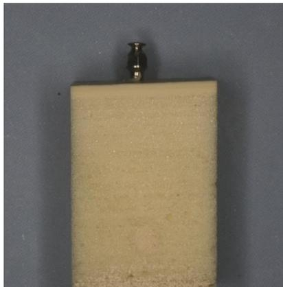
FIGURA 22 - Fotografia do mini-implante inserido no bloco ósseo sintético com 1,0 mm de espessura de osso cortical.
