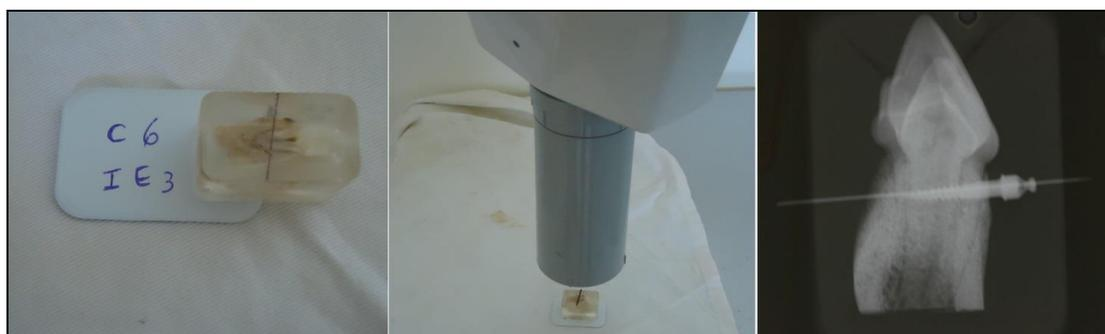
FIGURA 12 - Fotografias ilustrando a técnica radiográfica para localização do centro do longo eixo do mini-implante.
